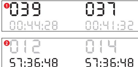
Счетчик кругов распознает автомобиль, когда он проезжает через фотопрерывный барьер. Можно устроить гонки по кругу ① или гонки на время ②. При этом можно настроить максимум 999 кругов или 59 минут и 59 секунд.
