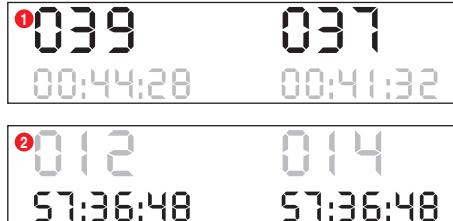
Počítadlo kol rozpozná vozidlo při průjezdu světelnou závorou. Je možné absolvovat závod na kola ① nebo závod na čas ②. Je přitom možné nastavit maximálně 999 kol nebo 59 minut a 59 sekund.
