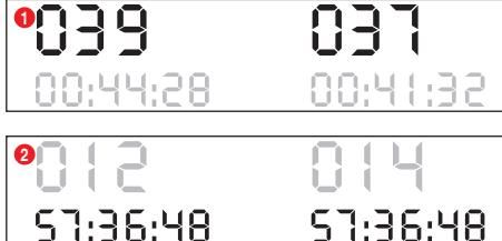
Der Rundenzähler erkennt ein Fahrzeug beim Durchfahren der Lichtschranke. Es können Rundenrennen ① oder Zeitrennen ② absolviert werden. Dabei können maximal 999 Runden oder 59 Minuten und 59 Sekunden eingestellt werden.
