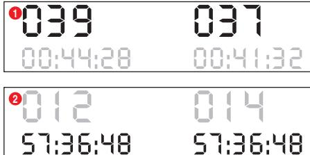
Il contagiri riconosce una vettura all'attraversamento della barriera fotoelettrica. È possibile effettuare gare a giri ① o a tempo ②, impostando al max. 999 giri o 59 minuti e 59 secondi.
