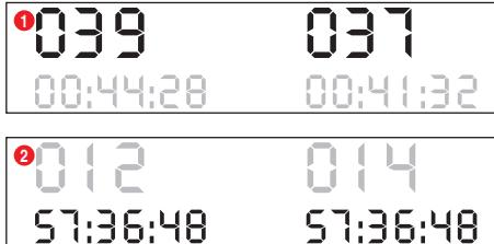
De rondeteller herkent een voertuig bij het doorrijden van de lichtbarrière. Er kunnen ronderaces ① of tijdraces ② afgewerkt worden. Daarbij kunnen maximaal 999 ronden van 59 minuten en 59 seconden worden ingesteld.
